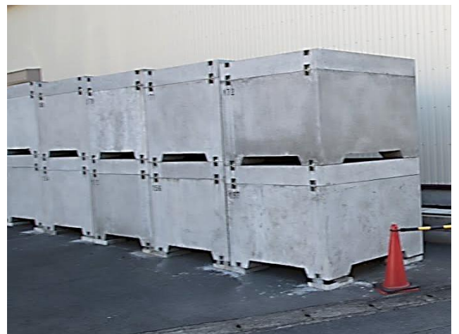
《コンクリートボックスによる保管の強化》 ※写真は千葉県松戸市における保管状況
