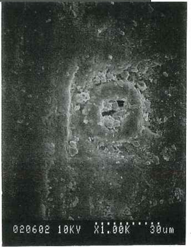
マツの気孔に付着したばいじん(埼玉県所沢市) 電子顕微鏡写真 松崎(筑波大学)・関口(信州大学)
