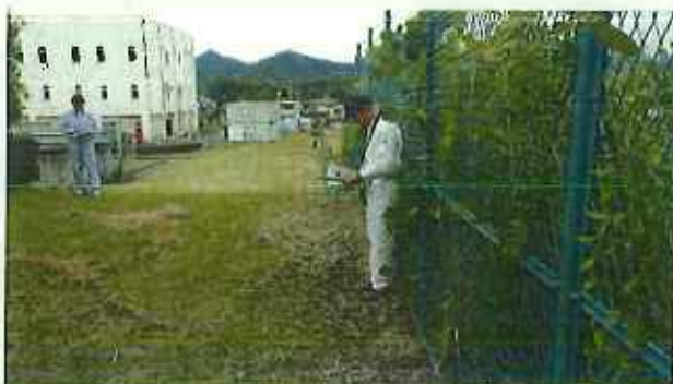
空間線量測定、敷地境界 保管場所直近
