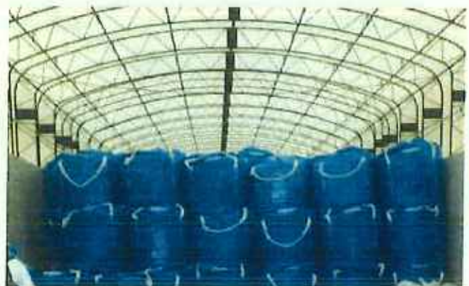
飛灰の保管状況
